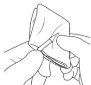
Pulire le parti con una garza o un panno in microfibra (ad esempio, Toraysee for CE - Panno di pulizia per apparecchiature e strumenti medici) che è stato inumidito con acqua di rubinetto per rimuovere i contaminanti visibili. Asciugare quindi completamente l'umidità con un panno morbido.
