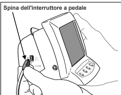
Inserire completamente la spina dell'interruttore a pedale nell'apposita presa, situata sul lato del Modulo di preparazione del canale radicolare e fotopolimerizzazione.
