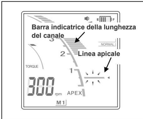
La posizione dell'estremità della punta viene indicata sul display dalla barra indicatrice della lunghezza del canale. La linea apicale lampeggia quando la punta viene inserita all'interno del canale radicolare.
