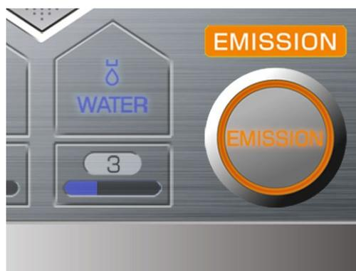
(4) Appuyez à fond sur la commande au pied pour émettre le faisceau laser. La touche Ready (Prêt) passera à Emission (Émission), et l'appareil émettra un bip continu.
