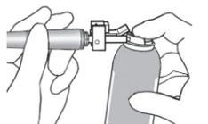
Setzen Sie die Sprühdüse in das Handstück-Anschlussende ein, halten Sie sie fest und sprühen Sie 2 Sekunden lang.
