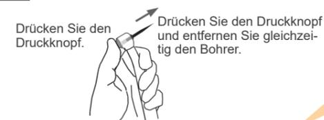
Drücken Sie den Druckknopf fest herunter und ziehen Sie den Bohrer gerade heraus.
