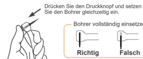
Drücken Sie den Druckknopf fest nach unten und führen Sie den Bohrer gleichzeitig bis zum Anschlag ein.
