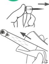
Entfernen Sie den Bohrer vom Handstück, schalten Sie den Wasserversorgungsschalter der Zahnbehandlungseinheit ein und lassen Sie das Handstück 20 Sekunden lang laufen.
