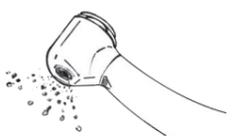
Schließen Sie das Handstück an den Schlauch an. Lassen Sie das Handstück mindestens 15 Sekunden lang laufen, um das überschüssige Öl aus dem Kopf herauszublasen und wischen es dann mit einem Stück Gaze ab. Trennen Sie das Handstück vom Schlauch.
