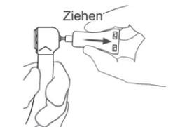
Ziehen Sie vorsichtig am Spannfüterprüfer, bis die Rille sichtbar wird.
