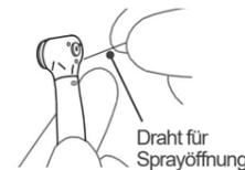
Befestigen Sie an der WL-Clean-Dose einen geeigneten Adapter. Stecken Sie den Adapter in das Anschlusse des Handstücks und sprühen Sie dreimal jeweils 2 Sekunden lang. Nehmen Sie das Handstück dann aus dem Adapter und legen Sie es beiseite. Warten Sie mindestens 1 Minute, bis das Reinigungsmittel zu wirken beginnt.
