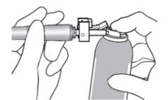
Introduzca la boquilla del pulverizador en el extremo de la conexión de la pieza de mano, sujete con fuerza y pulverice durante 2 segundos.
