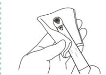
Acople un adaptador adecuado a la lata de WL-clean. Introduzca el adaptador en el extremo de la conexión de la pieza de mano. Pulverice en cada uno 3 veces durante 2 segundos. Retire la pieza de mano del adaptador y colóquela aparte. Espere al menos 1 minuto hasta que el agente limpiador haga efecto.
