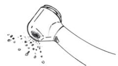
Conecte la pieza de mano a su tubo. Use la pieza de mano durante al menos 15 segundos para expulsar el exceso de aceite del cabezal, y luego límpiela con un trozo de gasa. Desconecte la pieza de mano del tubo.
