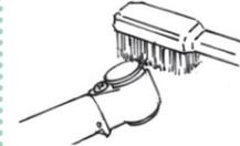
Limpie las piezas con agua corriente y un cepillo de dientes. Limpie el orificio del pulverizador con el hilo metálico para orificio del pulverizador y enjuague la pieza de mano con agua corriente.
