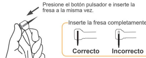
Inserte la fresa completamente.
