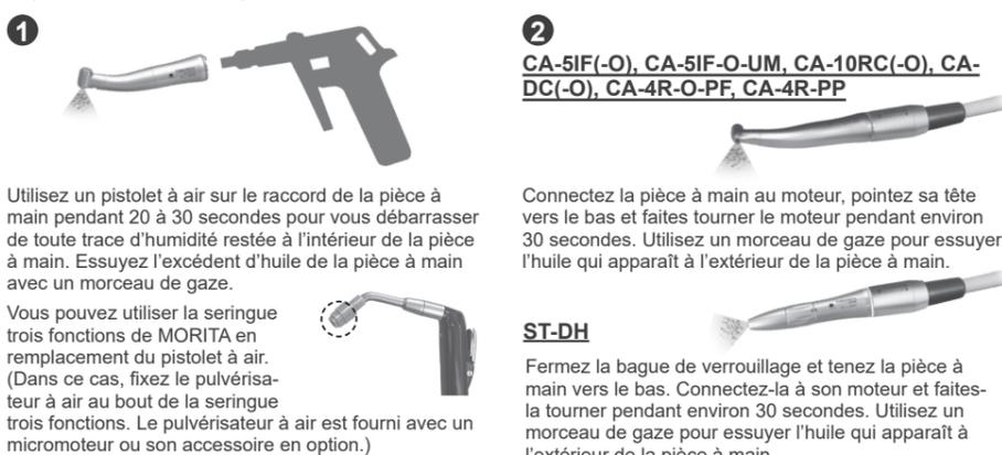
1 Utilisez un pistolet à air sur le raccord de la pièce à main pendant 20 à 30 secondes pour vous débarrasser de toute trace d'humidité restée à l'intérieur de la pièce à main. Essayez l'excédent d'huile de la pièce à main avec un morceau de gaze.
