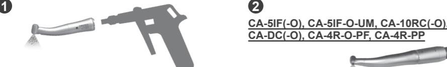
Zračnim pištoljem ispuhujte priključak nasadnika 20 do 30 sekundi kako biste uklonili preostalu vlagu iz nasadnika. Gazon uklonite višak ulja s nasadnika.
