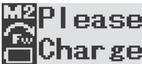
Si prácticamente no queda batería, el Tri Auto mini se apagará automáticamente después de 10 segundos. Recargue la batería en cuanto pueda.
