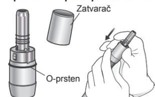
Nakon sterilizacije primijenite malo spreja LS SPRAY ili MORITA MULTI SPRAY na O-prsten i zatvarač mikromotora, a zatim postavite poklopac za motor izravno na mikromotor.
