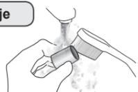
Očistite ostatke rezanja i paste za poliranje četkom pod mlazom vode. Nakon čišćenja upotrijebite štrcaljku ili pištolj za zrak kako biste uklonili preostalu vlagu iz poklopca za motor.
