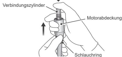
Halten Sie den Schlauchring sowie die Motorabdeckung fest und drücken mit Ihrem Daumen den Verbindungszyylinder herunter, um die Abdeckung vom Mikromotor abzustreifen.
