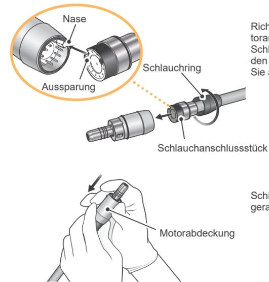
Richten Sie die Nase am Mikromotoranschluss mit der Aussparung im Schlauchanschluss aus und schieben Sie den Schlauch auf den Mikromotor. Ziehen Sie anschließend den Schlauchring fest.
