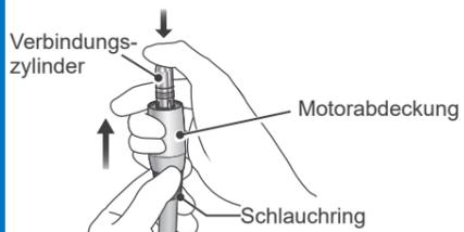
Halten Sie den Schlauchring sowie die Motorabdeckung fest und drücken mit Ihrem Daumen den Verbindungszyylinder herunter, um die Abdeckung vom Mikromotor abzustreifen.
