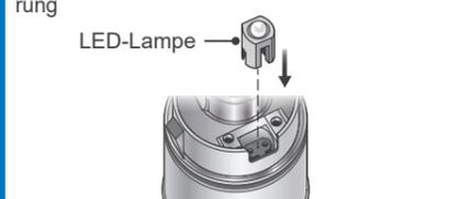
Befestigen Sie die Lampenhalterung mit 2 Schrauben. Schieben Sie die Motorabdeckung wieder gerade auf den Mikromotor auf.
