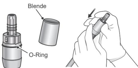
Sprühen Sie etwas LS OIL oder MORITA MULTI SPRAY auf den O-Ring und den Verschluss des Motorabdeckung. Schieben Sie anschließend die Motorabdeckung gerade auf den Mikromotor.
