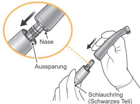
Schieben Sie das Handstück gerade auf den Verbindungszylinder des Mikromotors, bis es hörbar einrastet. Handelt es sich um ein Handstückmodell mit Licht, drehen Sie das Handstück so, dass die Nase in die Aussparung des Mikromotors passt. Wenn die Nase in die Aussparung einrastet, wird ein hörbares Klicken erzeugt.
