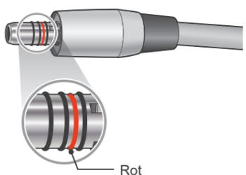
Entfernen Sie die O-Ringe mit einer Pinzette oder einem ähnlichen Werkzeug und setzen die Ersatzteile ein. Stellen Sie sicher, dass der rote O-Ring in der richtigen Position sitzt.
