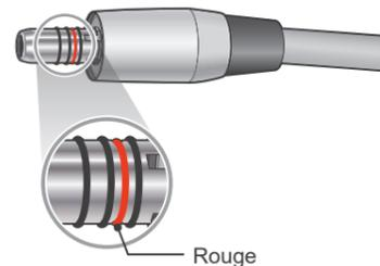
Retirez les joints toriques à l'aide de brucelles ou d'un outil similaire, et installez les pièces de rechange. Assurez-vous que le joint torique rouge est placé au bon endroit.
