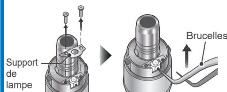
Dévissez les 2 vis et retirez le support de lampe. Insérez l'extrémité des brucelles dans la rainure de la lampe DEL et tirez dans le sens indiqué par la flèche sur l'illustration.
