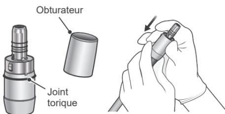
Appliquez une petite quantité d'LS OIL ou de MORITA MULTI SPRAY sur le joint torique et l'obturateur du couvercle du moteur, puis faites glisser le couvercle du moteur sur le micromoteur.
