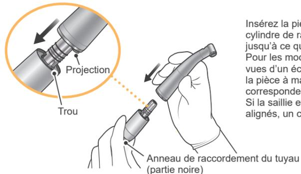
Insérez la pièce à main directement sur le cylindre de raccordement du micromoteur jusqu'à ce qu'elle s'enclenche fermement. Pour les modèles de pièces à main pourvus d'un éclairage, tournez légèrement la pièce à main de façon à ce que la saillie corresponde à l'orifice du micromoteur. Si la saillie et l'orifice sont parfaitement alignés, un clic sonore se fait entendre.
