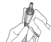
Nettoyez les pièces avec un morceau de gaze ou un tissu en microfibre (p. ex., Toraysee for CE - tissu d'entretien du matériel et des instruments médicaux) humidifié avec de l'eau du robinet pour éliminer les contaminants visibles. Essayez ensuite l'humidité avec un tissu doux.
