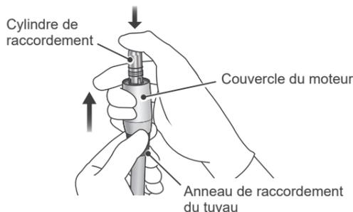
Tout en maintenant l'anneau de raccordement du tuyau, saisissez le couvercle du moteur et appuyez sur le cylindre de raccordement avec le pouce pour faire glisser le couvercle hors du micromoteur.
