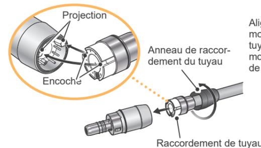
Alignez la saillie sur le raccord du micromoteur avec l'encoche sur le raccord du tuyau et faites glisser le tuyau sur le micromoteur. Ensuite, serrez fermement l'anneau de raccordement du tuyau.
