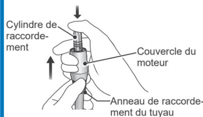
Tout en maintenant l'anneau de raccordement du tuyau, saisissez le couvercle du moteur et appuyez sur le cylindre de raccordement avec le pouce pour faire glisser le couvercle hors du micromoteur.
