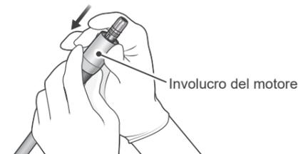
Far scorrere l'involucro del motore indietro, lungo il micromotore.
