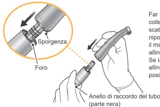
Far scorrere il manipolo nel cilindro di collegamento del micromotore fino a farlo scattare in posizione. Per i modelli di manipolo dotati di luce, ruotare leggermente il manipolo in modo che la sporgenza si allinei con l'apposito foro nel micromotore. Se la sporgenza e il rispettivo foro sono allineati correttamente, si udirà lo scatto in posizione.
