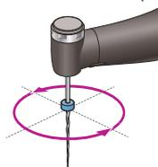
Pour le paramètre CW, le moteur effectue une rotation continue à 360° dans le sens des aiguilles d'une montre. Pour le paramètre CCW, le moteur effectue une rotation continue à 360° dans le sens inverse des aiguilles d'une montre.
