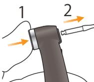
(7) Serrez fermement la vis, puis maintenez le bouton-poussoir enfoncé et retirez la barre de guidage.
