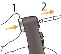
(5) Serrez fermement la vis, puis maintenez le bouton-poussoir enfoncé et retirez la barre de guidage.
