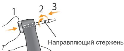
(2) Удерживая нажатой кнопку, вставьте направляющий стержень и поворачивайте его назад и вперед, пока он не встанет в паз защелки. Затем отпустите кнопку, чтобы зафиксировать стержень.
