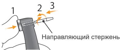
(4) Удерживая нажатой кнопку, вставьте направляющий стержень и поворачивайте его назад и вперед, пока он не встанет в паз защелки. Затем отпустите кнопку, чтобы зафиксировать стержень.
